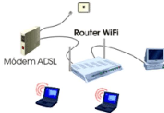
Figura 5. Conexión a través del modem
